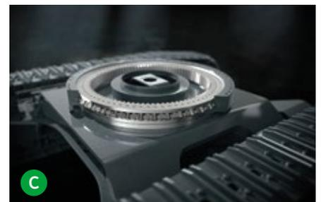
*Robuste, hochbelastbare Pendellagerkonstruktion für erhöhte Tragkraft und reduzierte Ausfallzeiten.*
