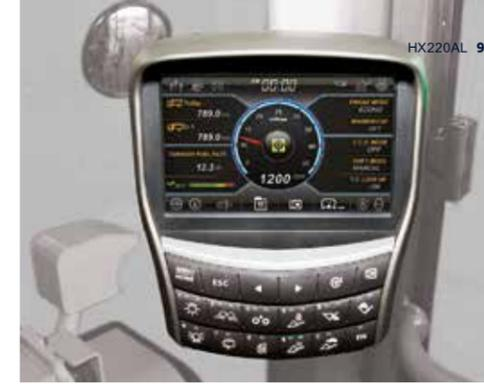
Die **Instrumententafel** ist für schnellen, einfachen Zugriff auf Maschinenstatusinformationen während der Arbeit optimiert. Sie enthält einen leicht ablesbaren **8"-Touchscreen**.
