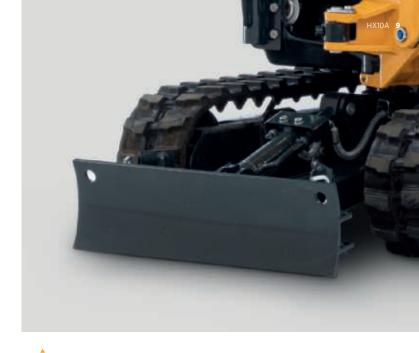
Der verlängerbare Planierschild ermöglicht das Planieren über die volle Breite der Kette.
