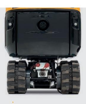
Ein externer Hydraulikölbehälter hält das Öl ohne zusätzliches Kühlsystem kühler. Dies schützt die Leistungsfähigkeit bei hohen Umgebungstemperaturen.
