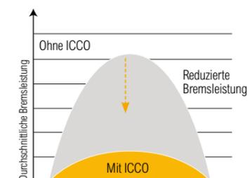
Die **intelligente Kupplungstrennfunktion (ICCO)** minimiert den Leistungsverlust im Drehmomentwandler und verhindert übermäßige Leistungsverluste beim Bremsen. Das reduziert die Wärmeentwicklung und den Verschleiß der Bremsscheibe.
