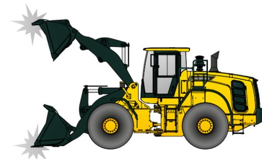
Die **Soft-Stop-Funktion** reduziert die Geschwindigkeit der Hydraulik gegen Ende des Zylinderhubs. Das verringert die Stoßbelastung beim Hub, erhöht den Bedienkomfort und sorgt für weniger verschüttetes Material.
