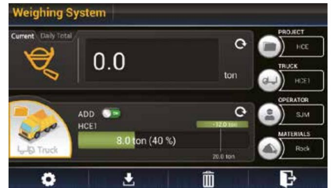
Das kumulative **Präzisionswiegesystem mit automatischer und manueller Einstellung** hilft Ihnen, in jeder Umgebung effizienter zu arbeiten. Zur Erhöhung der Präzision erscheinen bei Wiegefehlern Symbole und eine zweifarbige Gewichtswertanzeige im Display.
