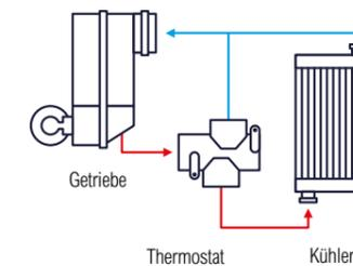
Der HL980HD verfügt über einen **Thermostaten für die Getriebekühlung**. Dieses Merkmal erleichtert das rasche Erwärmen der Flüssigkeit und erhält sie auf der optimalen Betriebstemperatur, wodurch die Komponenten geschützt und die Effizienz gesteigert werden.
