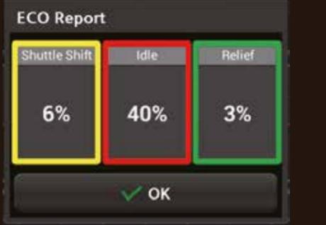
Mithilfe des **Eco-Berichts** kann sich der Bediener Echtzeitdaten zur Maschinenleistung anzeigen lassen und so leicht eine effiziente Arbeitsweise angewöhnen.
