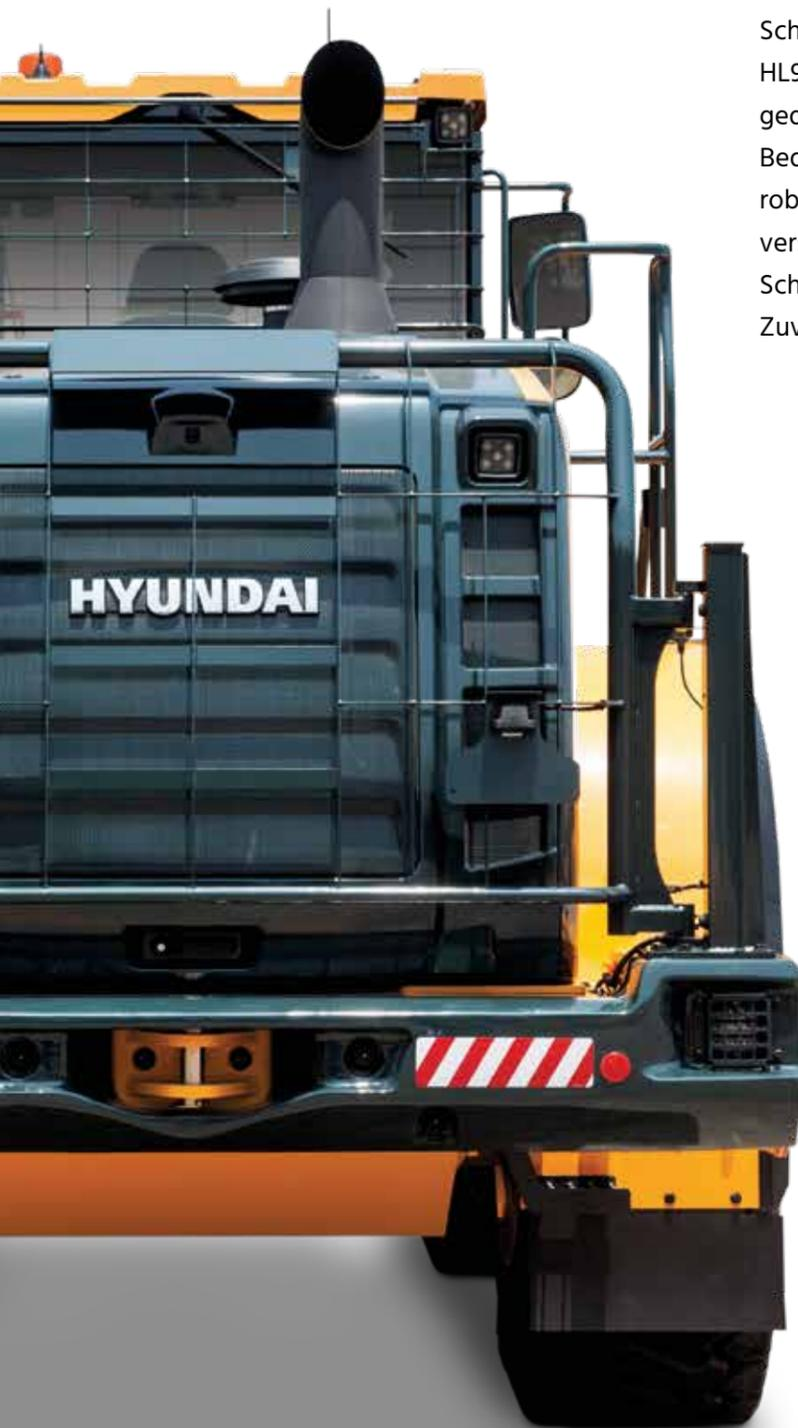
Ein **Schutzgitter** am Heck schützt Rückfahrkamera, Arbeitsscheinwerfer, Kennzeichenleuchte und Kühler vor herabfallenden Gegenständen. Die Sicht des Bedieners wird aber nicht behindert. Das Stahlgitter ist wegklappbar und bietet leichten Zugang zum Kühler zur Reinigung oder täglichen Wartung.
