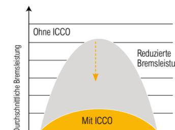
Die **intelligente Kupplungstrennfunktion (ICCO)** minimiert den Leistungsverlust im Drehmomentwandler und verhindert übermäßige Leistungsverluste beim Bremsen. Das reduziert die Wärmeentwicklung und den Verschleiß der Bremsscheibe.
