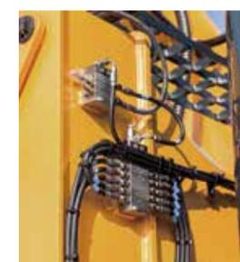
Die optionale **automatische Schmierung** schmiert die Schmierpunkte nach Bedarf. Immer mit der richtigen Dosierung und mit gleichmäßigem Auftrag für minimalen Schmiermittelverbrauch und weniger Verschwendung.
