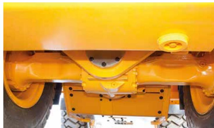
Die **Achsen** des HL960AHD sind für absolute Zuverlässigkeit und Schwerlast-Dauerbetrieb ausgelegt. Die Achse bietet hervorragende Stabilität und Kraftübertragung, ist aber gleichzeitig kompakt und leicht ausgeführt. Der Einsatz nasser Lamellenbremsen verringert die Bremsverluste und verbessert dadurch die Effizienz.
