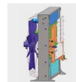
Der HL960A verfügt über einen zuverlässigen **Luftkühler mit breitem Kern und Flügeln**, der einen Leistungsabfall durch Verunreinigung verhindert. Außerdem enthält er einen **Umkehrlüfter**, der Staub und Schmutz fernhält.
