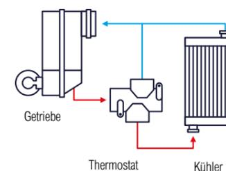
Der HL960A verfügt über ein **Thermostat für die Getriebekühlung**. Dieses wärmt das Öl schnell auf und hält es im Winter immer auf der optimalen Betriebstemperatur, was die Komponenten schützt und die Effizienz erhöht.
