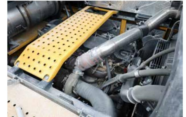
Das Herz des Sany SY500 HRD: ein Cummins-QSG12-Sechszylinder mit einer satten Leistung von 298 Kilowatt/400 PS
